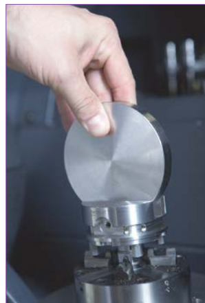
Figs. 5 y 6. Bloque de cromo-cobalto y detalle del fresado.
